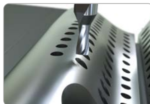
Bohrungen bis 60° Neigungswinkel in konvexe Oberflächen.
