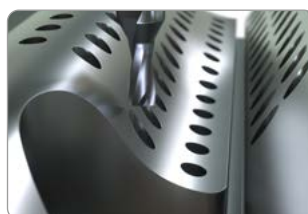
Bohrungen bis 60° Neigungswinkel in konkave Oberflächen.
