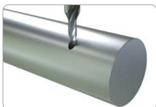
Exzentrische Bohrungen in konvexe Oberflächen.
